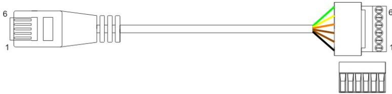
Die Steuereingangspins der Sensoreingänge sind mit den Pins 2 und 3 verbunden. Der Ausgang des Controllers ist im Open Collector Modus mit Pin 2 und Pin 6 und im Closed Collector Modus mit Pin 3 und Pin 6 verbunden.
